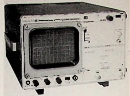
National Matsushita VP-3601 A: programmeerbare oscilloscoop, geschikt om te worden opgenomen in automatisch testsysteem. Zeven functies in 6 (op bestelling 10) stappen te programmeren. Keuze van voorinstelde programma's d.m.v. drukknoppen of afstandbedieningseenheid.
